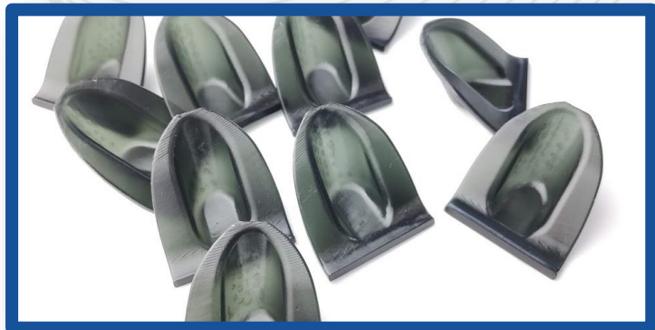
Реставрация военного Хаммера (печать из фотополимера)
