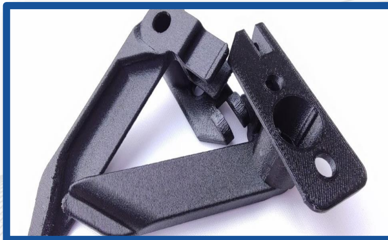
Реставрация военного Хаммера (печать из фотополимера)
