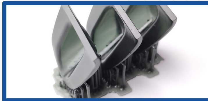
Реставрация военного Хаммера (печать из фотополимера)
